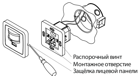
Рис. 2 Схема монтажа
